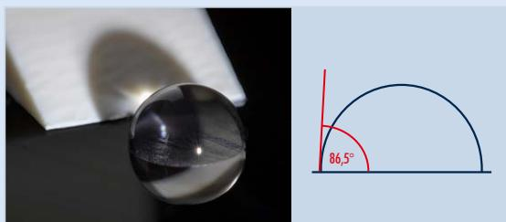
Каплю воды точно размещают на поверхности с помощью автоматического дозирующего устройства. Далее её подсвечивают со стороны. Тень от капли проецируется на наклонную поверхность. Специальная камера делает сверху фотоснимок высокого разрешения. Картина подвергается коррекции с учётом перспективы. Теперь форма капли определена и угол контакта измерен. Чем меньше угол, тем выше смачиваемость.
